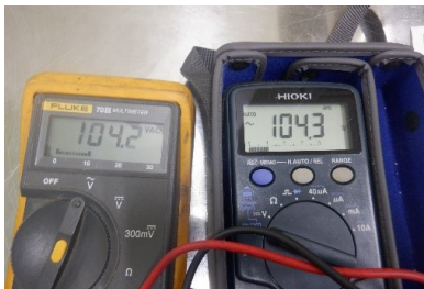
商業電源AC100V測定
